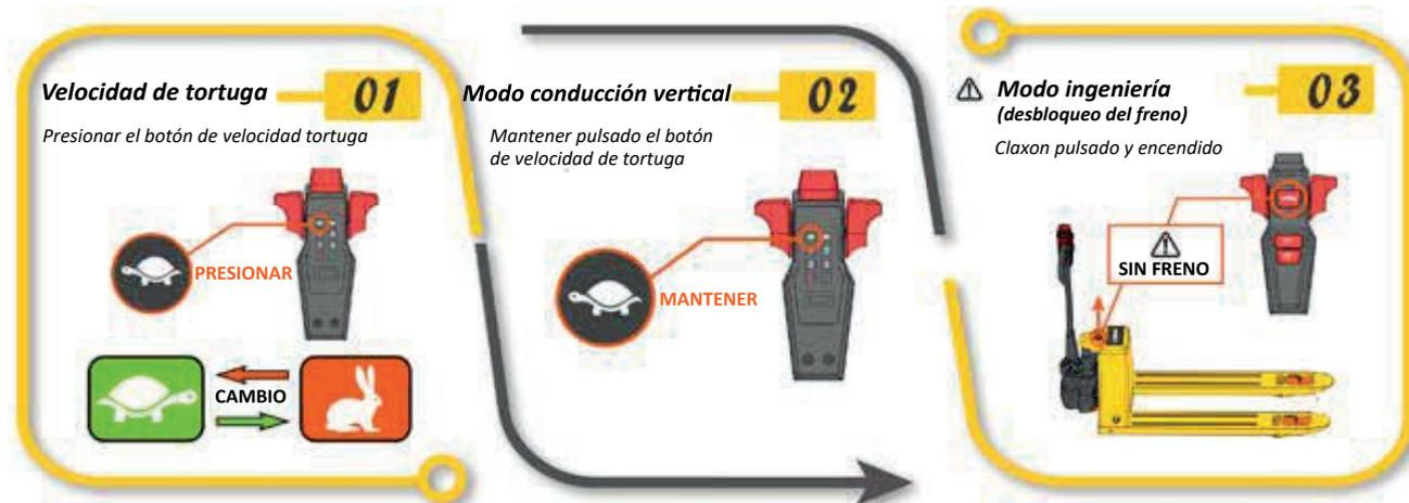
En el modo de conducción vertical, el vehículo se moverá cuando se accione el mango en cualquier posición. Por favor, evite la operación incorrecta.
