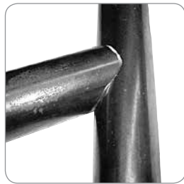
Entalle angulos a 60° en tubo o tubería hasta 3" en segundos, sin huecos y listo para soldar.
