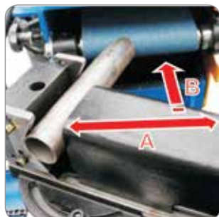
Alimentación y movimiento lateral simultánea
