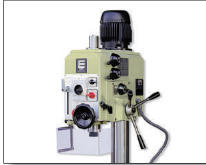
Volante frontal para avance sensitivo fino (TS) Frontal wheel for fine sensitive feed (TS) Volant frontal pour avance sensitif fine (TS) Vorderes handrad für den vorschub bei feinarbeitungen und plandreihen (TS)
