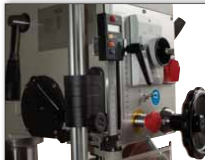
Lector digital de profundidad Depth digital reading Lecteur digital de profondeur Tief digitale Lesegerät
