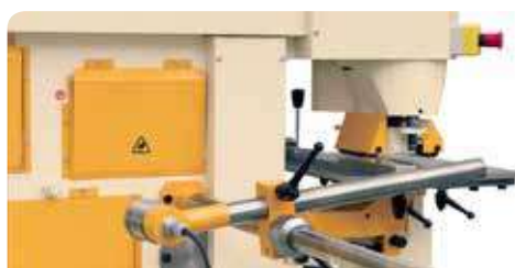
Topo eléctrico de un metro
