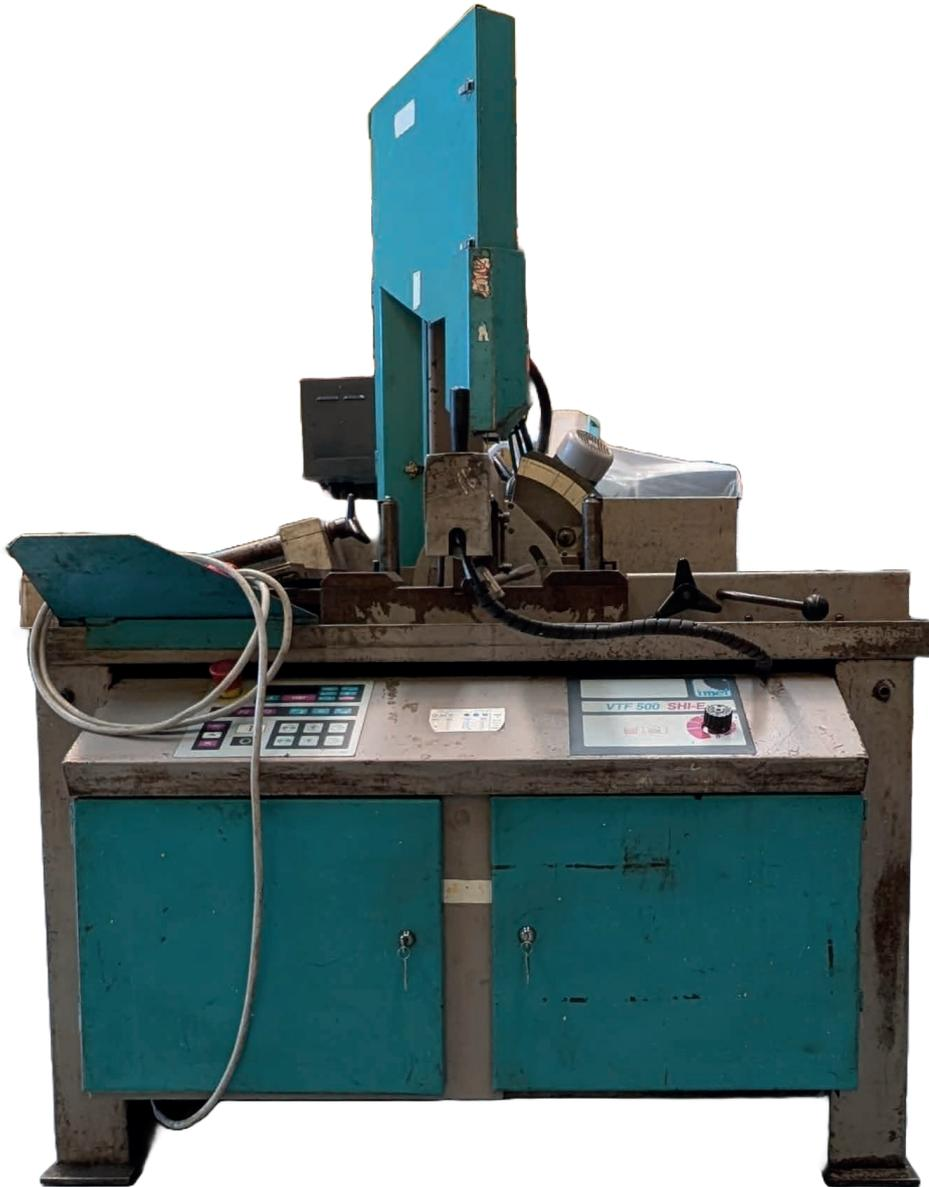
Sierra de cinta semiautomática hidráulica de corte frontal, y giro a la derecha y a la izquierda, hasta 45° respecto a la línea vertical.
