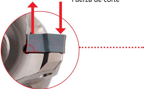
La geometría de la cavidad de la placa ensamblada evita que esta se levante y proporcione una sujeción estable sin utilizar brida de sujeción.
